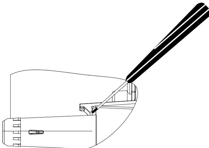
10. Separar el soporte de conexión, el transmisor y el soporte de fijación.
