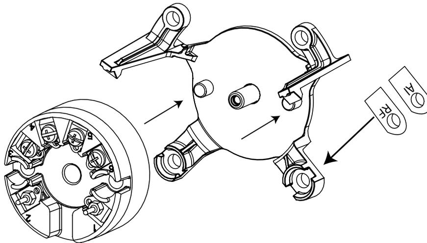
2. Deslice el soporte de conexión en el transmisor usando las uniones como guías. Asegúrese de que las clavijas doradas del conector en los terminales 1 y 2 del transmisor se deslicen en su lugar en los terminales correspondientes del soporte de conexión.
