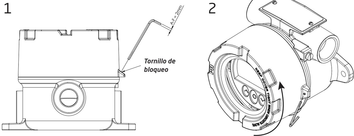
1. Libere el **tornillo de bloqueo**, usando una llave hexagonal plana de 2 [mm]. Este tornillo se sitúa en la parte superior del encapsulado.
