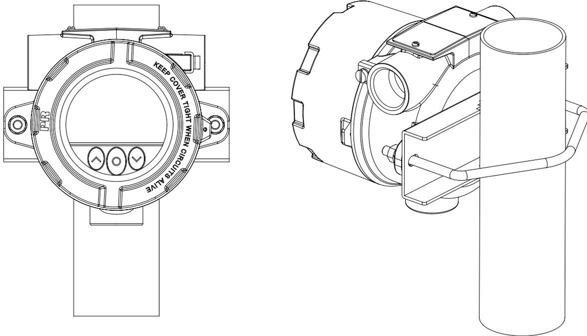
Montaje en tubería - vista superior
