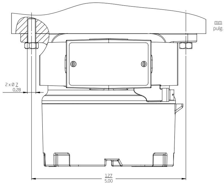
Montaje en tubería - vista de frente y vista posterior
