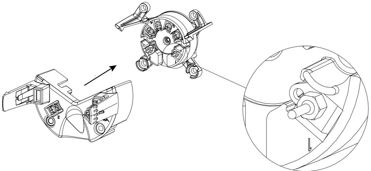
3. Deslizar el conjunto hacia atrás en el alojamiento y volver a fijar los 4 tornillos (a + b) con los tornillos de 28 mm para el soporte de conexión (a) y los tornillos 10 mm para el soporte de fijación (b).
