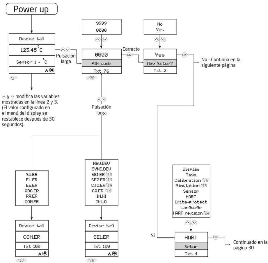
\*1 Si durante 60 segundos no se realiza ninguna pulsación (a excepción de las funciones de simulación y calibración), no se salva ningún parámetro y el dispositivo vuelve a la pantalla "Monitor". Si el escalado del display está habilitado, el valor de escala del display también está disponible y se muestra de forma predeterminada en la vista de "Monitor".
